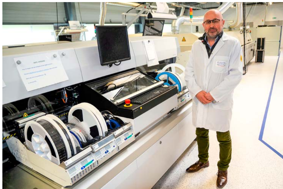
Bruno Sonnet, président de B3C, devant une nouvelle machine de placement CMS (composants montés en surface), acquise en février 2022. Elle va permettre d'augmenter la production et la flexibilité.
